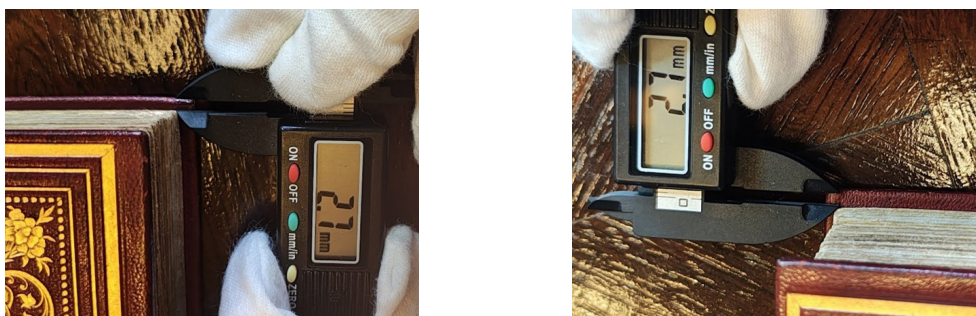
Figura 13 e 14 – Medição das borduras com paquímetro digital de alta precisão.
