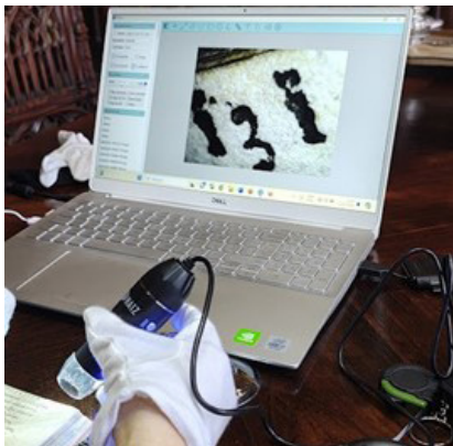
Figuras 70 e 71 – Imagem macroscópica da visualização microscópica da numeração da folha 131 e imagem microscópica da folha 37, demonstrando a irregularidade do trabalho tipográfico artesanal.
