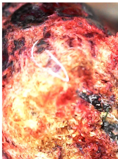
Figura 18 – Imagem microscópica de dano no revestimento, permitindo ver suas características constitutivas.
