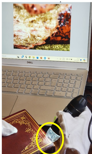
Figura 17 – Imagem macroscópica de dano no revestimento no ponto onde dispõem o microscópio.
