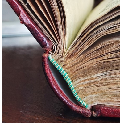
Figura 30 – Imagem macroscópica do cabeceado, da lombada redonda solta do miolo e do ângulo de abertura.
